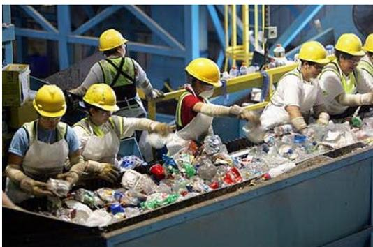
Figura 4. Separación manual de envases
